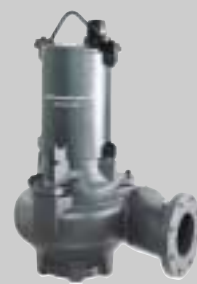
Linha SEN Bombas em aço inoxidável para efluentes industriais Q: até 790 m 3 /h ≈ 220 l/seg H: até 58 m
