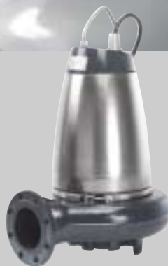
Linha SE1 Bombas para efluentes Q: até 290 m 3 /h ≈ 80 l/seg H: até 20 m
